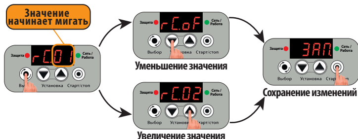
Графическое представление работы режима перезапуска "rC.02"
