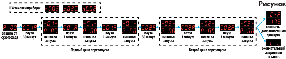
Графическое представление работы режима перезапуска "rC.02"
